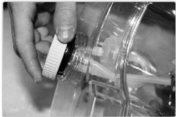
Снимите фильтр, хорошо промойте его и водяной бачок чистой водой. После этого снова установите фильтр в нижней части бачка и затяните его по часовой стрелке.
